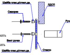
Если створка наклонена вправо или влево относительно вертикали корпуса, нужно выправить наклон створки в направлении А-А винтом 2.
